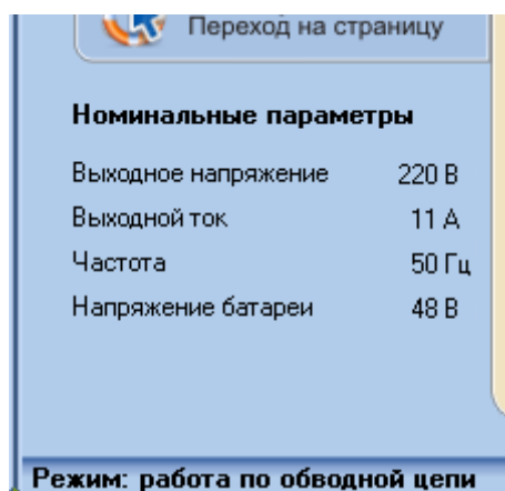
Рисунок 6 – Отображение номинальных параметров инвертора
